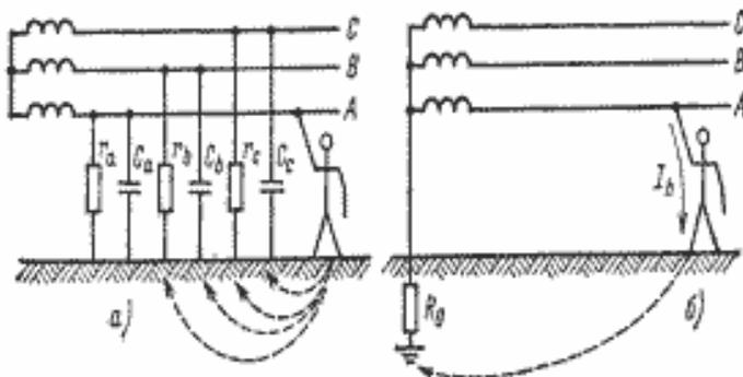
А Однофазное включение человека в цепь тока: а – в сети с изолированной нейтралью; б – в сети с заземленной нейтралью.
