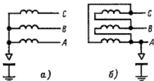
А защита от опасности перехода высокого напряжения на сторону низкого в сети напряжением до 1000 В: а – заземление одного из концов вторичной обмотки; б – заземление средней точки.
