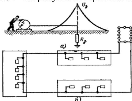
А контурного защитного заземления.
