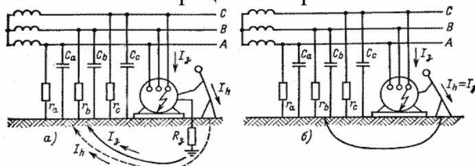
А прикосновение к корпусу, оказавшемуся под напряжением, для сети с изолированной нейтралью: а – при отсутствии заземления; б – при исправном заземлении.
