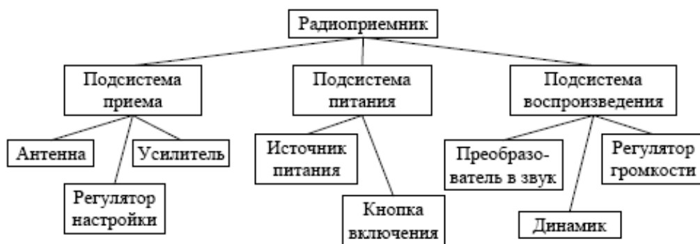
Рис. 1. Иерархия состава радиоприемника
