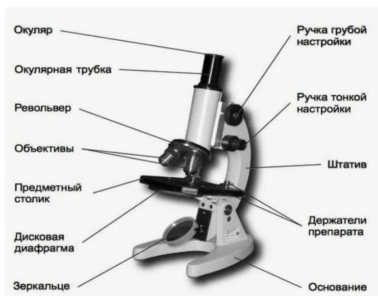
Рис.1 Устройство светового микроскопа
