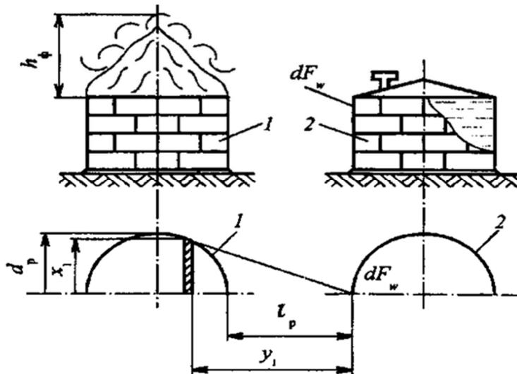
а) Схема гидродинамических и тепловых потоков, формирующих нагретый поверхностный слой
