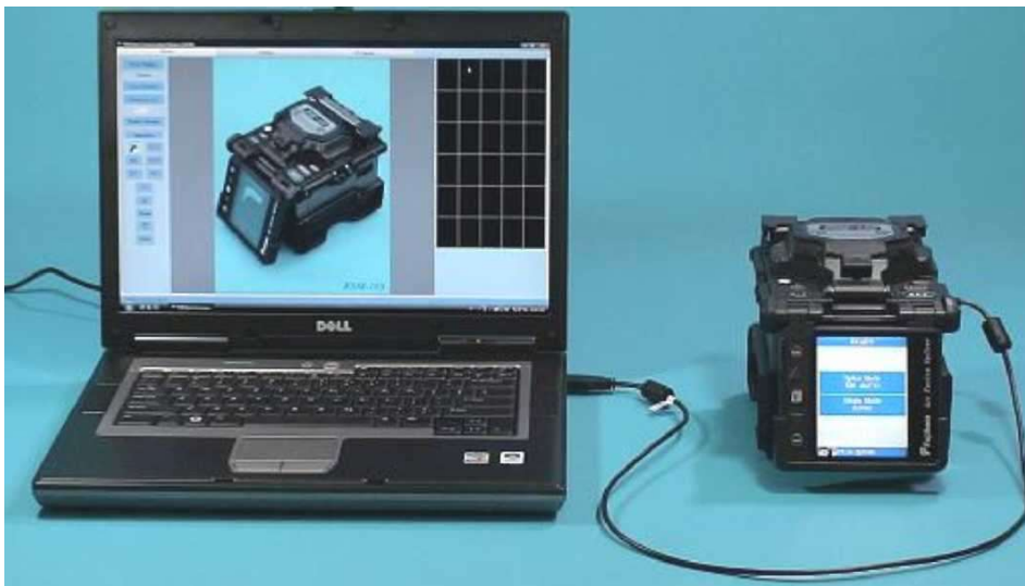
Рисунок 5.4 –Подключение сварочного аппарата FujikuraFSM-18S к ПК
