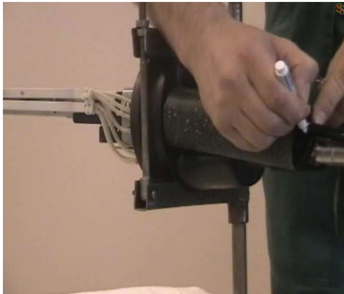
Рисунок 4.15– Отметка длины трубки на внешней оболочке кабеля
