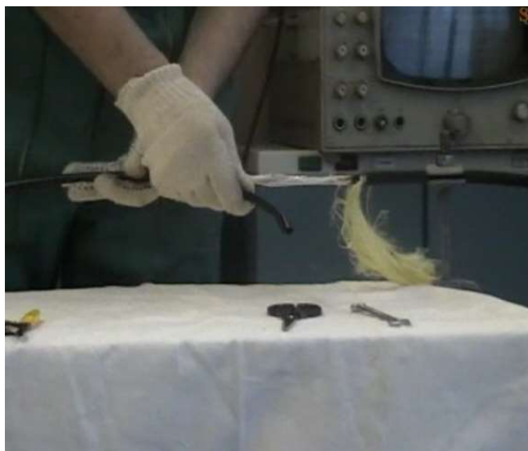
Рисунок 4.7 – Съём внутренней оболочки
