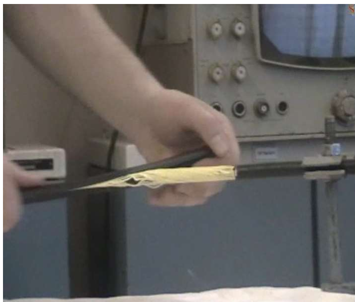
Рисунок 4.6 – Съём наружной оболочки
