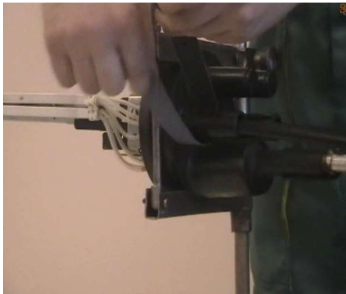
Рисунок 4.14– Обработка кабельного ввода
