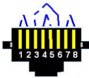
Рисунок 3.2 – Восьмиконтактное гнездо и расположение пар (вид разъема спереди)
