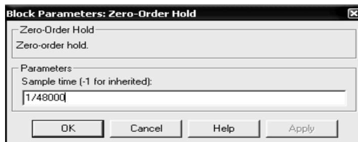
Рисунок 3 – Окно настройки параметров экстраполятора нулевого порядка
