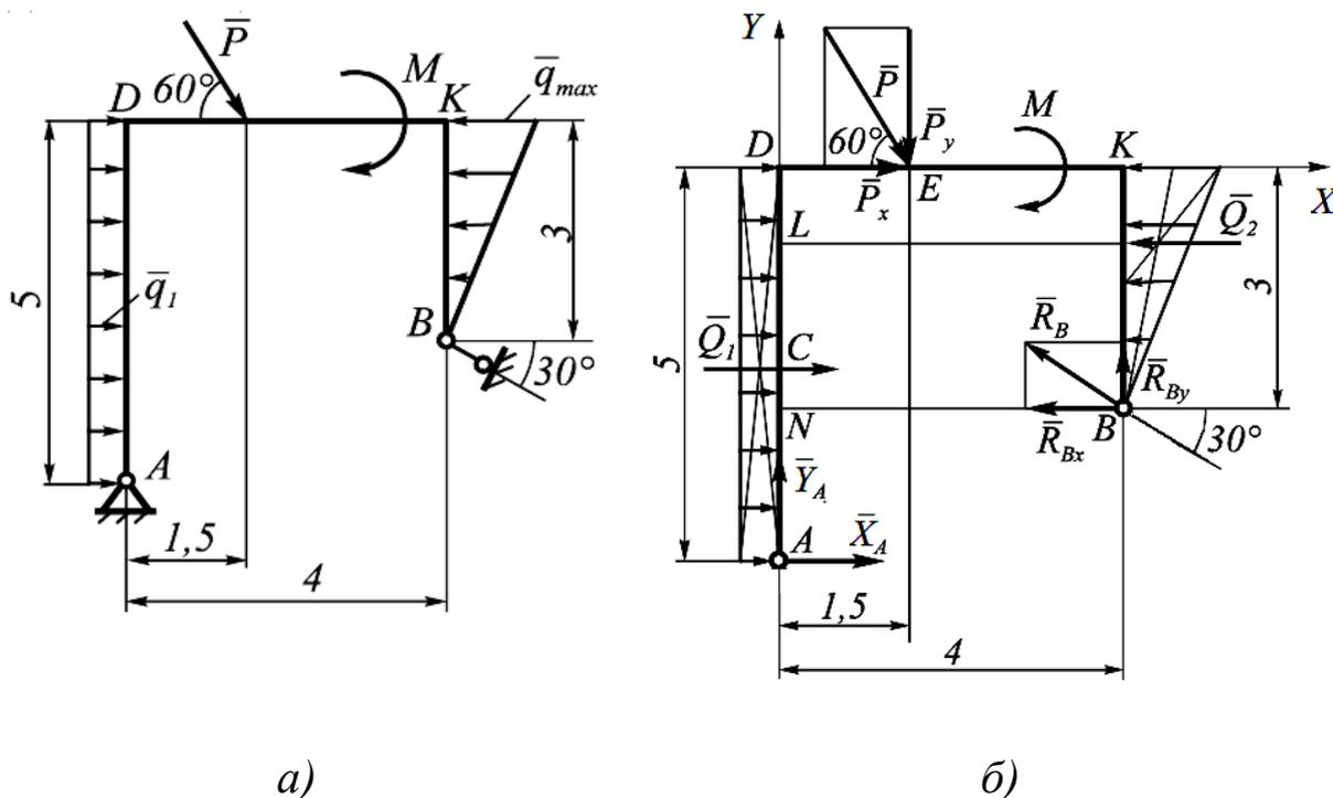
Рис.2.4. Схема рамы: а – исходная, б - расчётная
