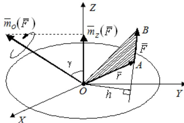
Рис. 1.5. Момент силы относительно центра и оси
