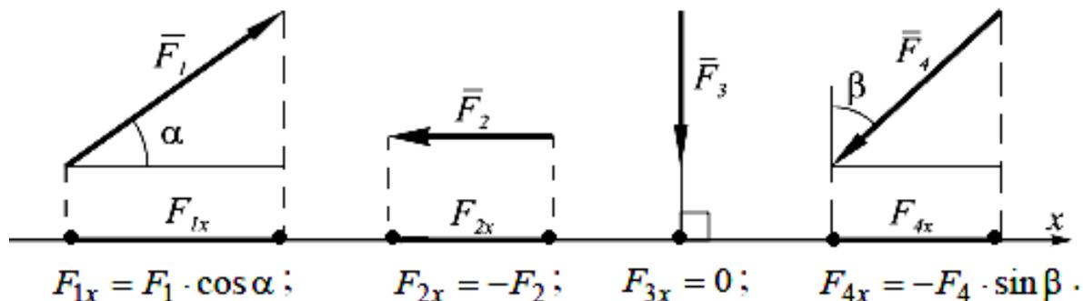
Рис. 1.3. Случаи нахождения проекций сил на ось координат
