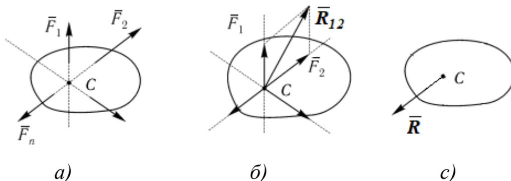
Рис.1.8. Система сходящихся сил: *a* - исходная система сил; *б* – сложение двух сил; *с* - эквивалентная система, приведенная к равнодействующей  $\bar{R}$
