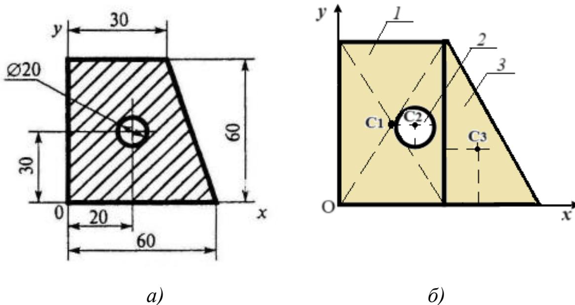
Рис. 3.20. Плоское сечение фигуры: *a* – исходная схема;
