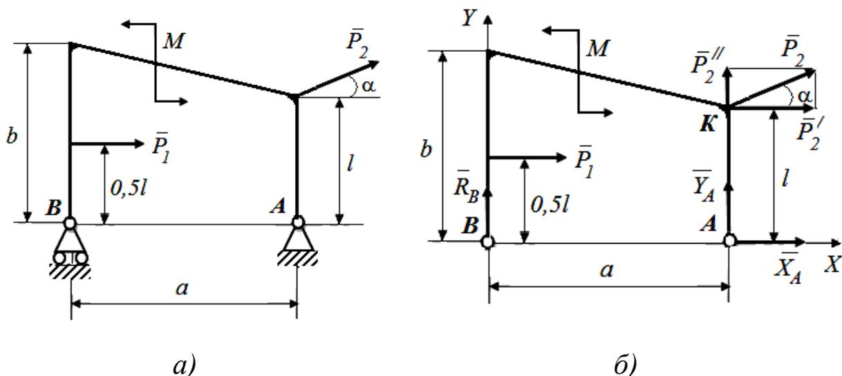
Рис.2.3. Схема рамы: а – исходная, б - расчётная
