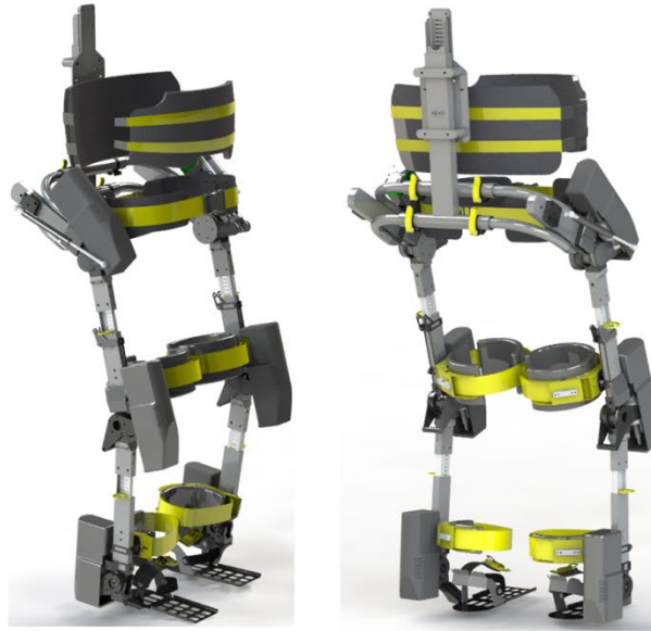
Внешний вид трехмерной модели реабилитационного экзоскелета
