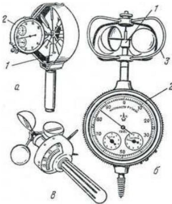
Рисунок 4 – Анемометры: а – ручной крыльчатый; б – ручной чашечный; в – ручной индукционный
