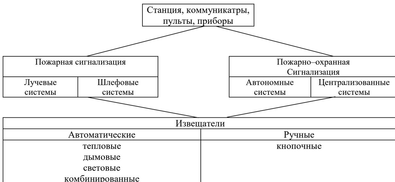
Рисунок 1 – Классификация систем пожарной и пожарно-охранной сигнализации
