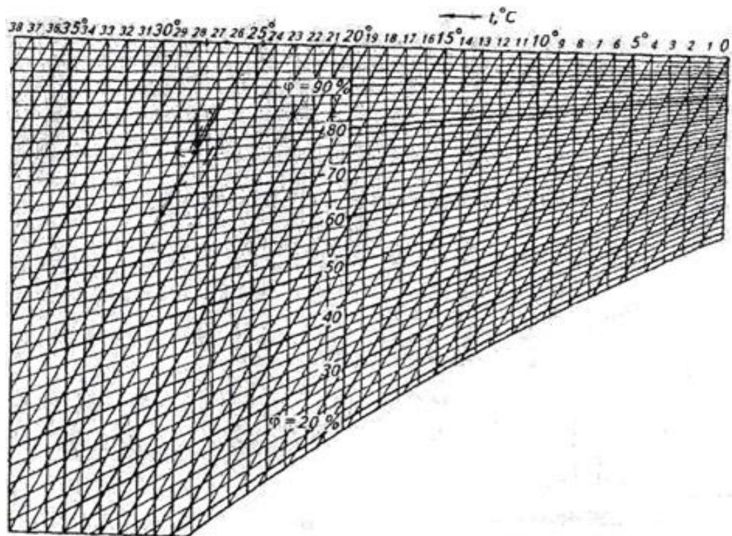
Рисунок 3 – Психрометрическая номограмма для определения относительной влажности воздуха
