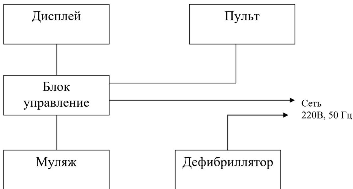
Рис. 1. Блок-схема тренажера «Витим-2»
