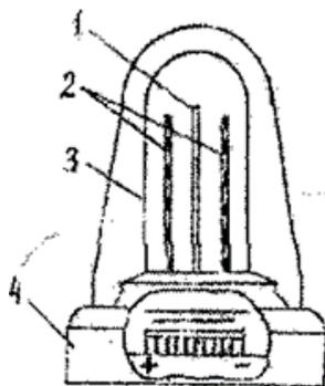
1 – катода, 2 – цилиндрический анод, 3 – стеклянный баллон, 4 – основание
