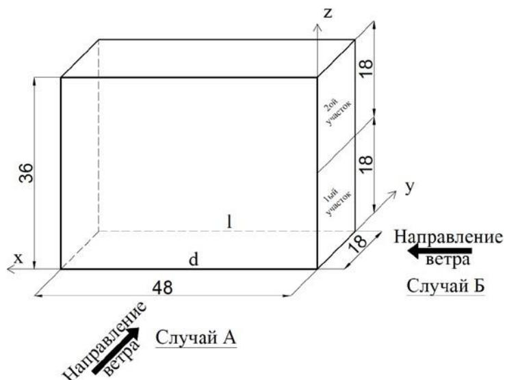
Рис. 1. Схема воздействия ветровой нагрузки на здание размером 48x18x36 метров.
