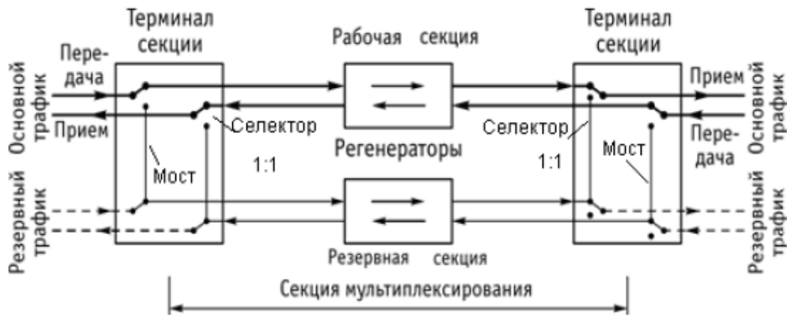
Рисунок 5 – Резервирование секции мультиплексирования 1:1
