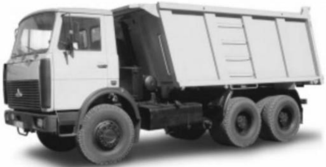
Рис. 8.3. Автосамосвал МАЗ-551605 грузоподъемностью 20 т производства Минского автомобильного завода
