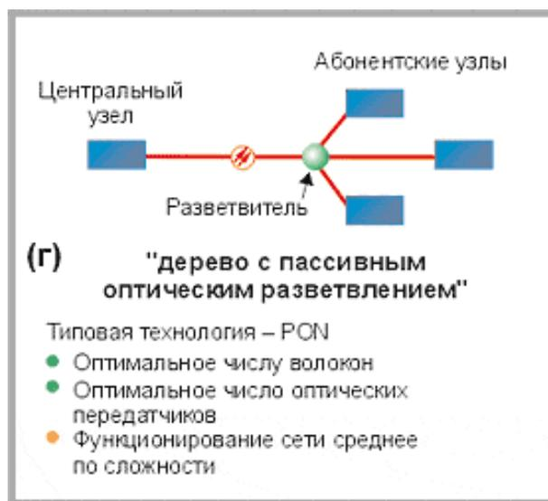
Рисунок 5 – Дерево с пассивным оптическим элементом PON-P2MP
