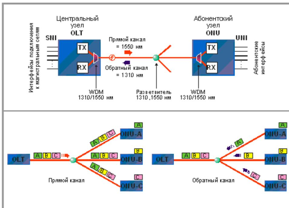
Рисунок 6 – Основные элементы архитектуры PON и принцип действия
