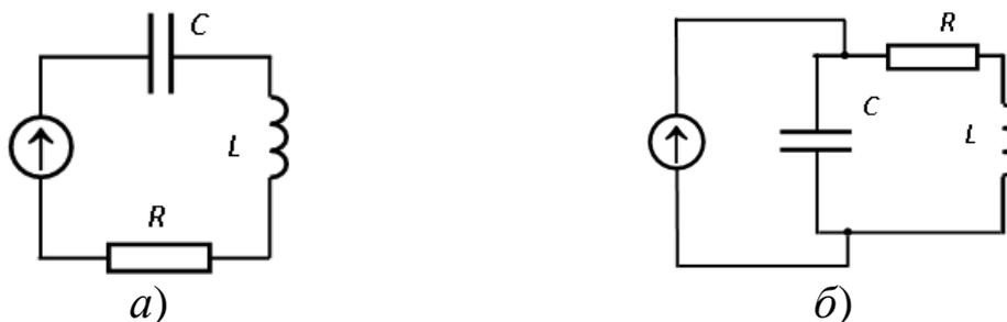
Рисунок 1 – Колебательные контуры
