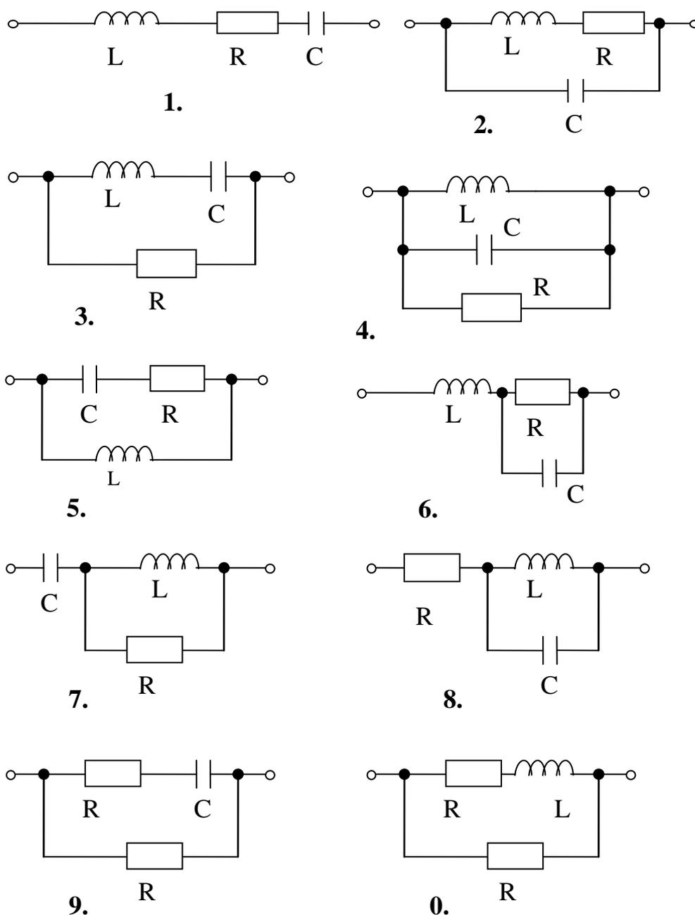
Рис.2.2. Схемы замещения продольных и поперечных сопротивлений ЧП
