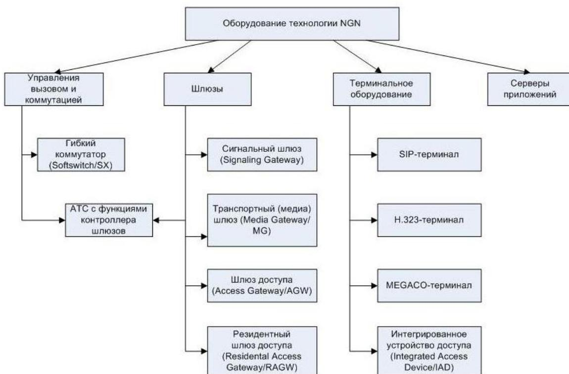
Рисунок 1 –Схема классификации типов оборудования NGN
