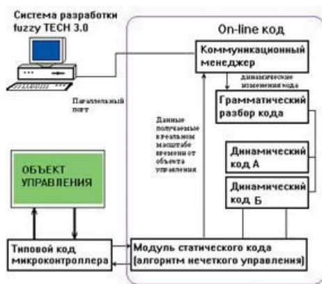
Рис. 4 – система управления при On-line-оптимизации
