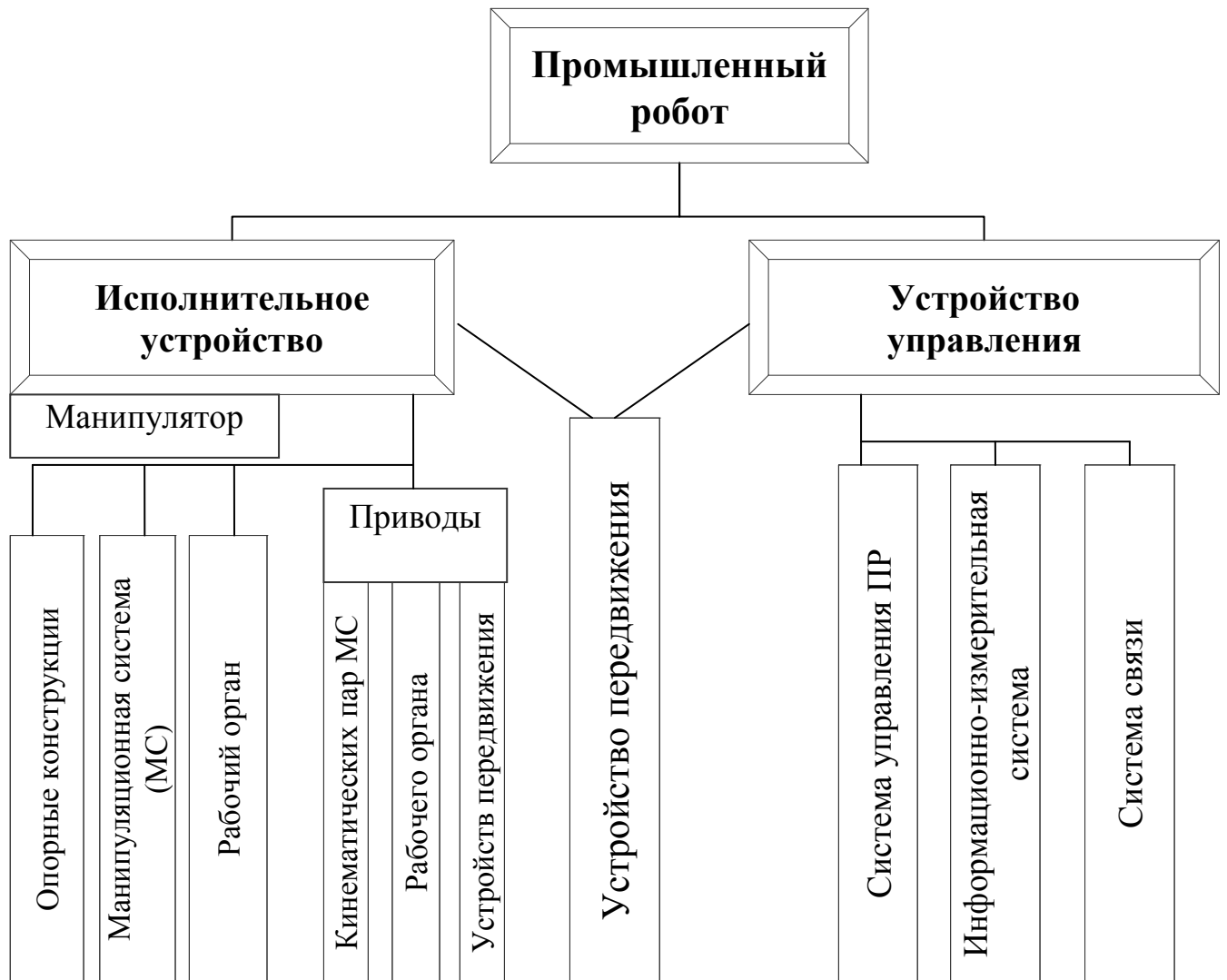
Рис.1. Составные элементы промышленного робота
