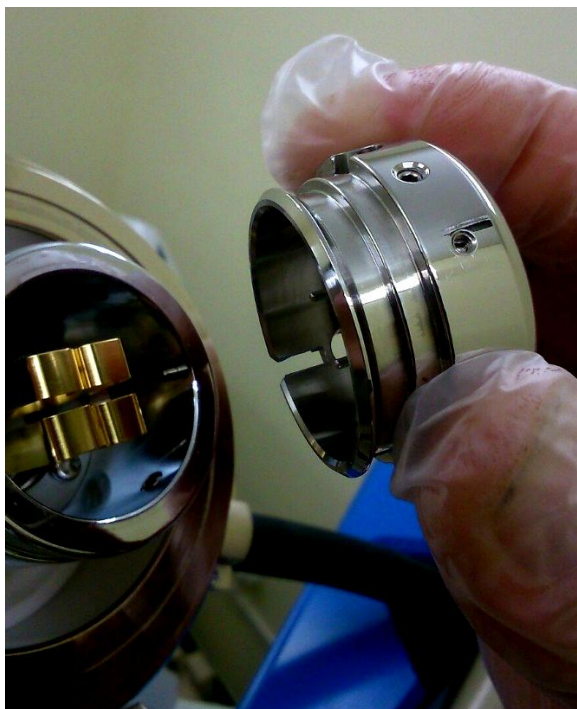
Рис. 9. Посадочное место катода
