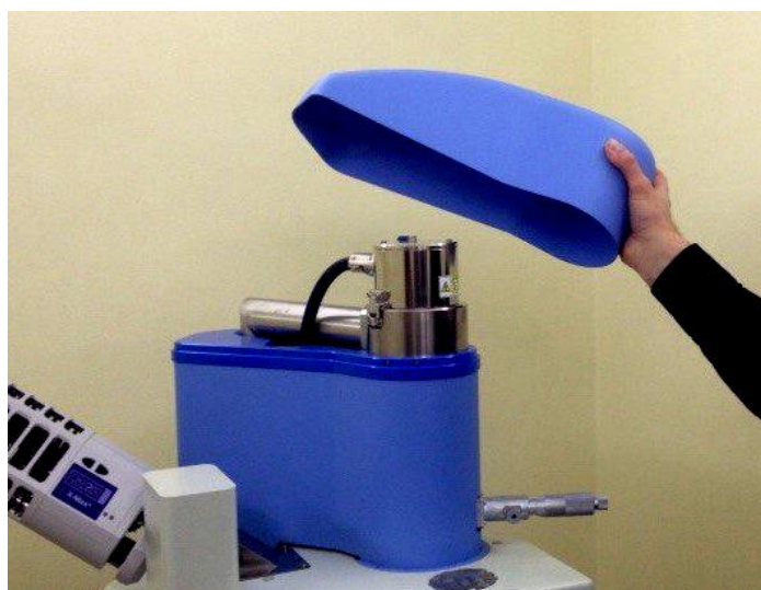
Рис. 8. Верхняя часть электронной колонны
