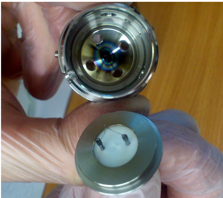
Рис. 11. Катод и корпуса электрода Венельта в разборе
