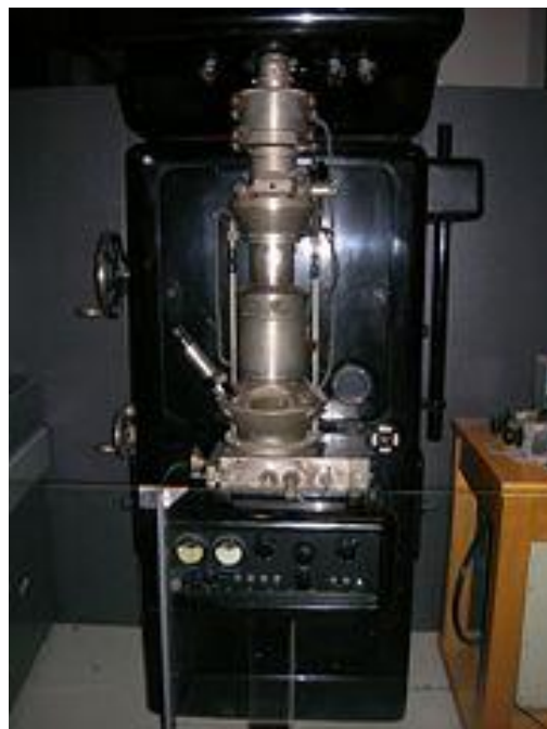
Рис. 1. Электронный микроскоп, сконструированный Эрнстом Руска
