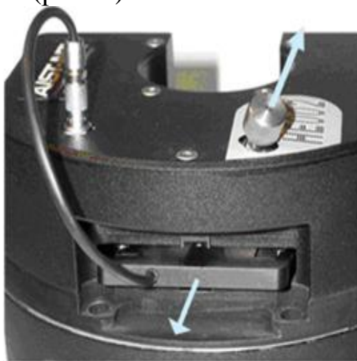
Рис. 9 Извлечение каретки зонда из измерительной головки СЗМ.
