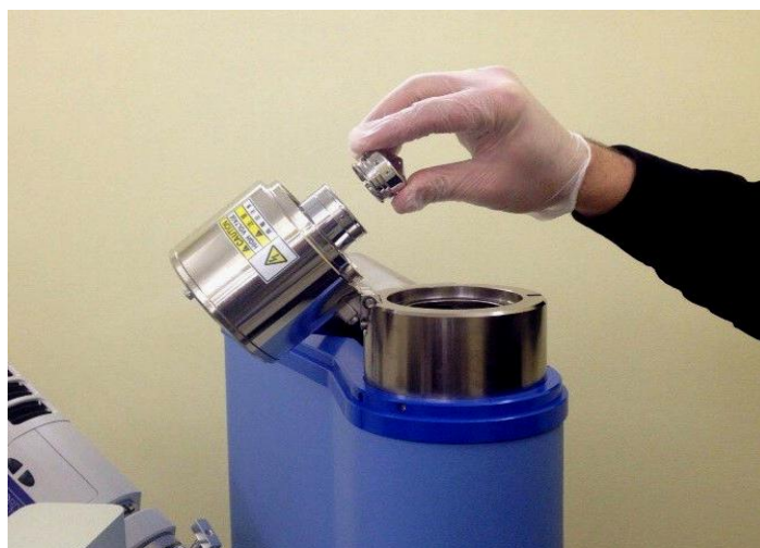
Рис. 15. Установка катода в катодный узел
