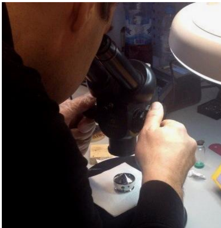
Рис. 13. Визуальный контроль качества очистки электрода Венельта
