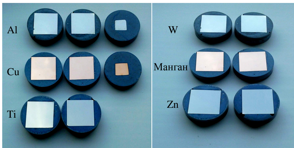
Рис. 4 Фотографии отполированных до качества поверхности 20 нм металлических электродов (2-го и 3-го типов).
