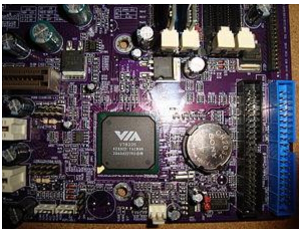
Рисунок 6 - Южный мост VIA 8235 (пример)
