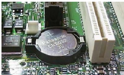
Рисунок 14 - Батарейка CR2032 на материнской плате (пример)
