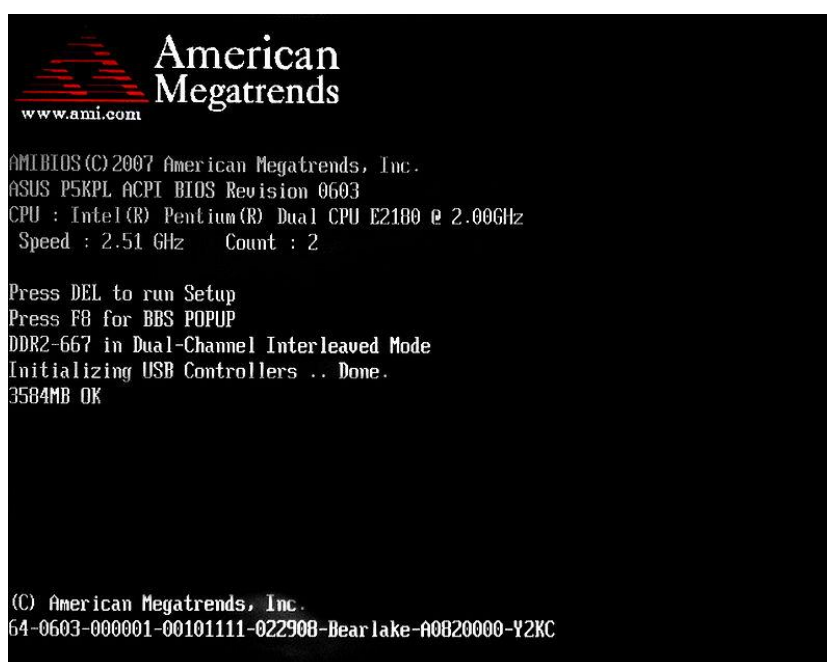
Рисунок 12 - Первый этап типичной операции POST (AMI BIOS)
