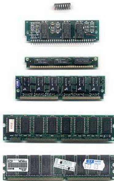
Рисунок 7 - Эволюционное развитие конструкции модулей памяти, используемые в качестве ОЗУ компьютера. Сверху вниз: DIP , SIPP, SIMM 30 pin, SIMM 72 pin, DIMM , DDR DIMM (пример)
