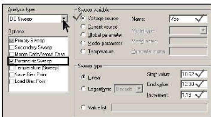
Рисунок 12 - Настройка параметров Parametric Sweep. Входные характеристики ( $U_{кэ0}=11,8\text{ В}$ )
