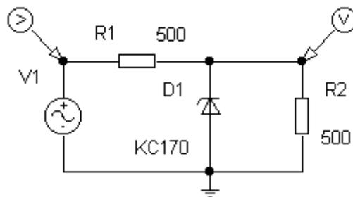
Рисунок 7 - Рабочая схема для исследования работы параметрического стабилизатора
