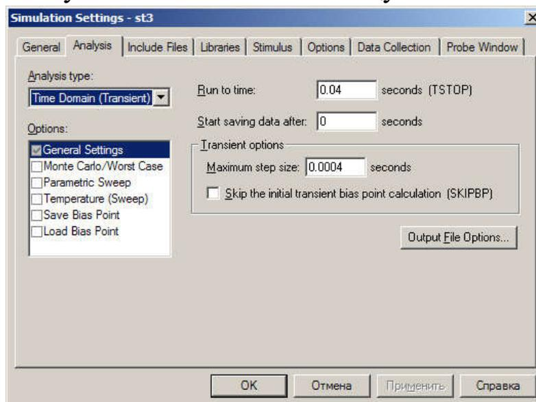
Рисунок 8 – Установки режима симуляции во временной области
