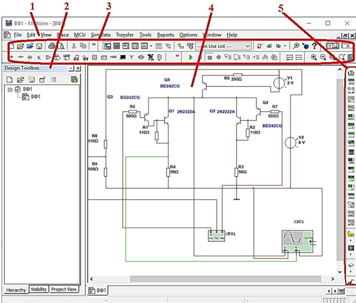
Рисунок 1 – Интерфейс Multisim
