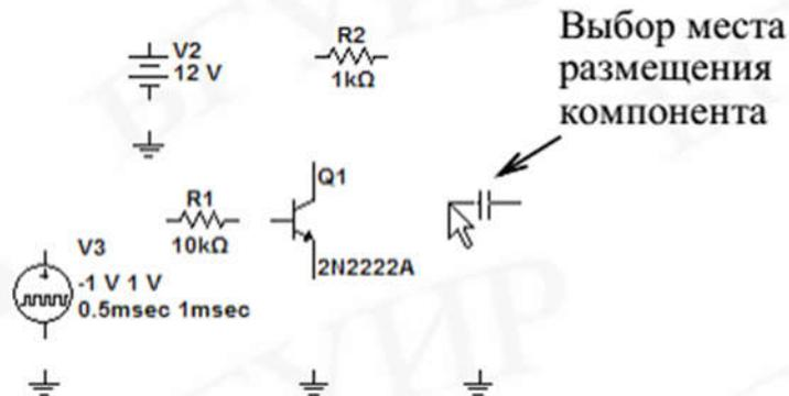
выбора компонентов схемы. Выбранный компонент автоматически прикрепляется к курсору мыши. После этого компонент размещается в любом месте рабочего окна (рисунок 10).
