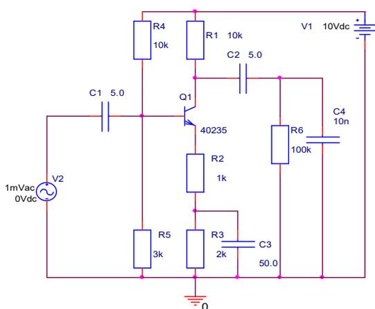
Рисунок 2 - Схема усилительного каскада с общим эмиттером
