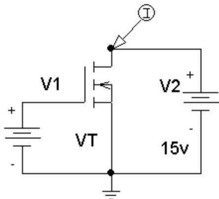
Рисунок 3 - Рабочая схема для снятия ВАХ полевого
