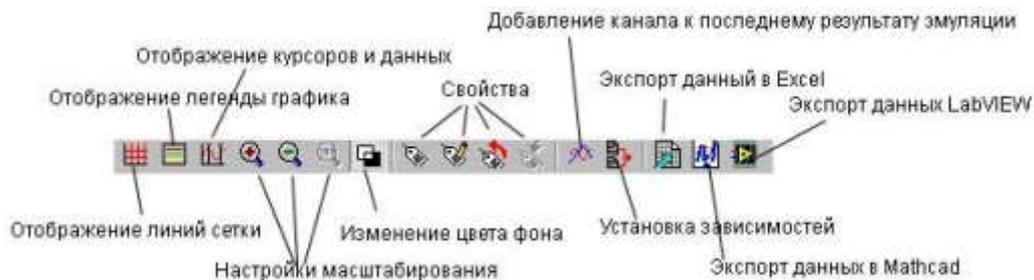
Рисунок 13 – Панель настройки плоттера
