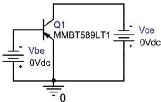
Рисунок 10 – Схема для снятия входных характеристик транзистора (OrCAD)
