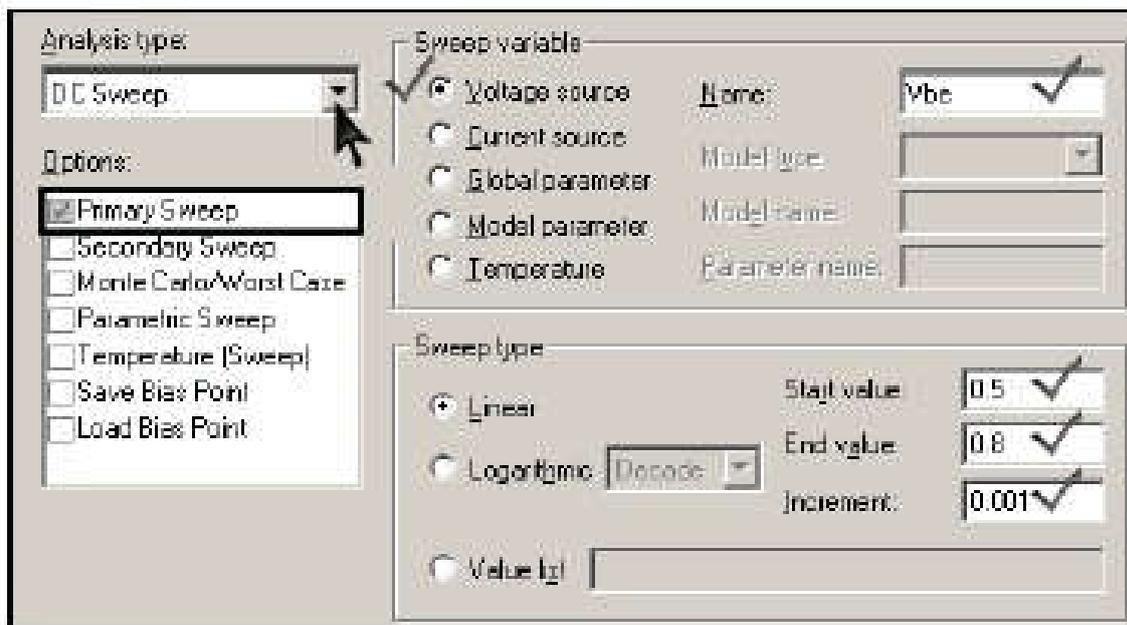
Рисунок 11 – Настройка параметров Primary Sweep. Входные характеристики
