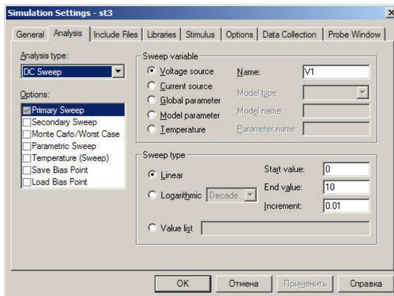
Рисунок 4.7 - Установки для построения передаточной характеристики
