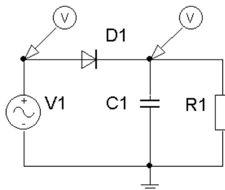
Рисунок 7 - Схема для моделирования однополупериодного выпрямителя.
