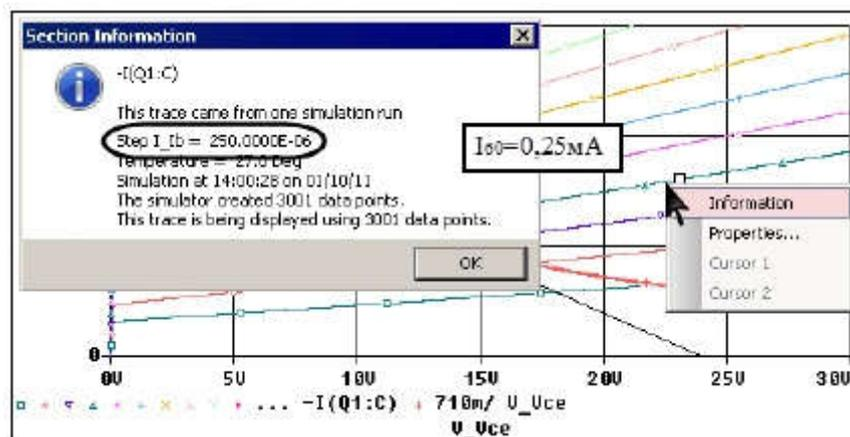
Рисунок 8 - Определение значения параметрической переменной
