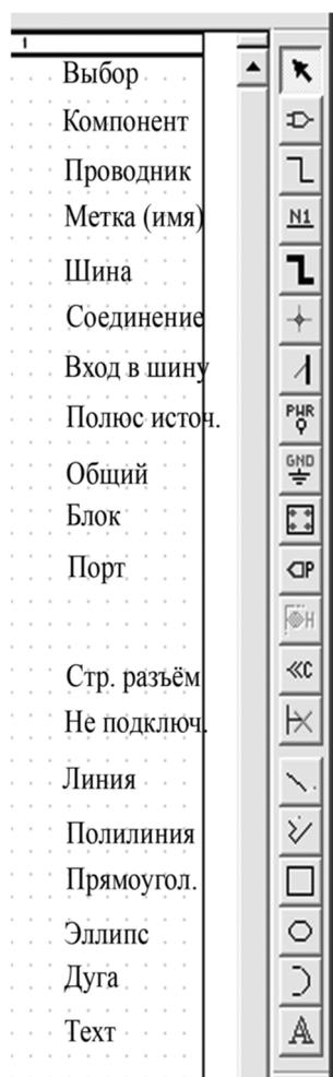
Рисунок 5 - Панель инструментов
