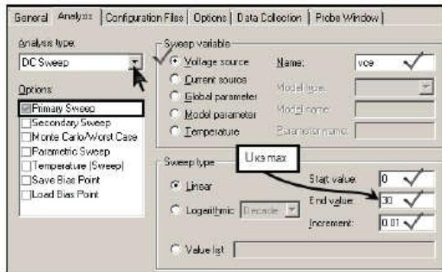
Рисунок 4.2 - Настройка параметров Primary Sweep. Выходные характеристики
