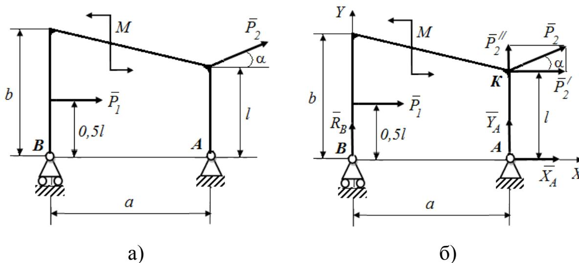
Рис.1.8. Схема рамы: а – исходная, б - расчётная
