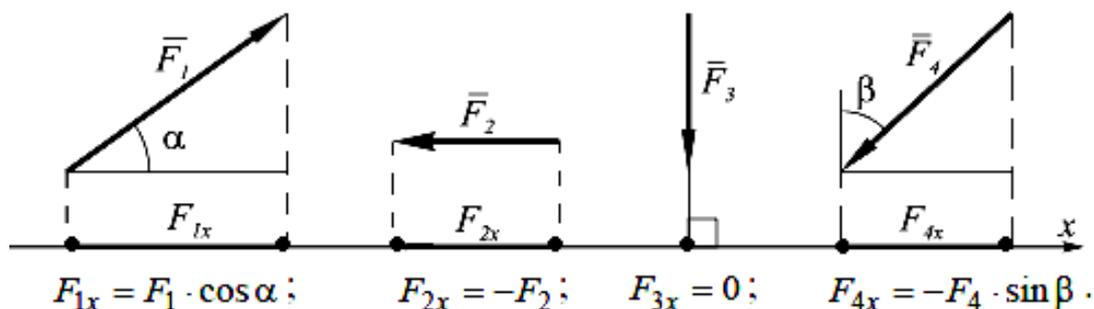
Рис. 1.3. Случаи нахождения проекций сил на ось координат
