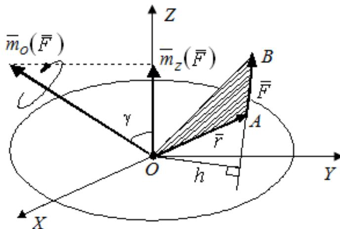
Рис. 1.4. Момент силы относительно центра и оси
