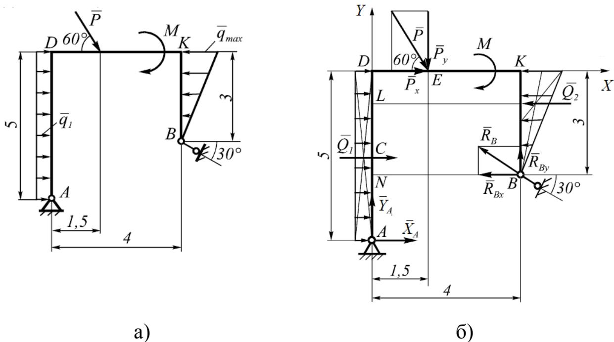
Рис.1.9. Схема рамы: а – исходная, б - расчётная
