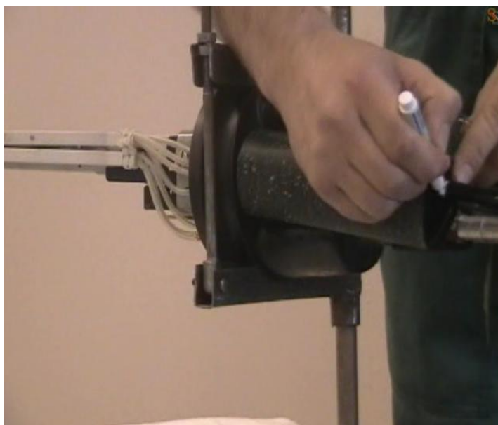
Рисунок 15 - Отметка длины трубки на внешней оболочке кабеля
