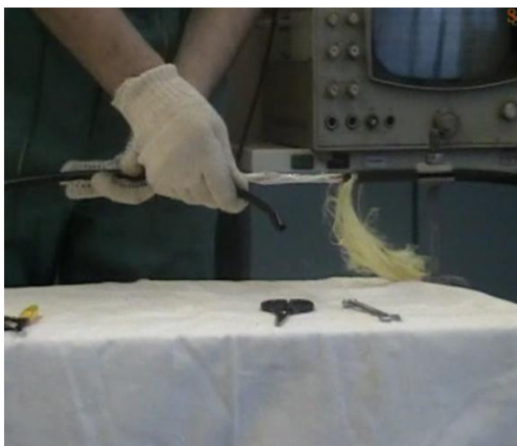
Рисунок 7 – Съем внутренней оболочки
