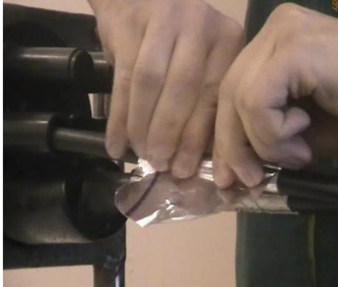
Рисунок 16 - Защита кабеля алюминиевой фольгой
