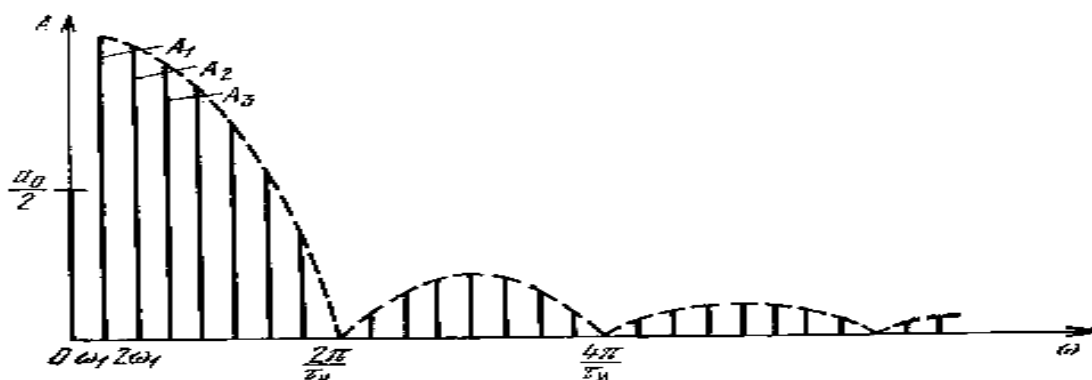
Рисунок 4 – Амплитудный спектр периодической импульсной последовательности
