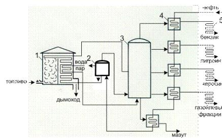
8. На приведенной схеме начальной стадии переработки нефти укажите испарительную колонну
