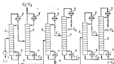
5. На технологической схеме разделения углеводородов C<sub>1</sub>-C<sub>5</sub> укажите кипятильник:
