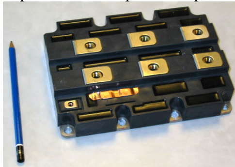
Рисунок 3.2 - Сборка на IGBT для коммутации напряжения до 3300 В и токов до 1200 А.
