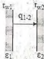
Рис.1. Расчетная схема теплообмена излучением между двумя поверхностями без экрана
