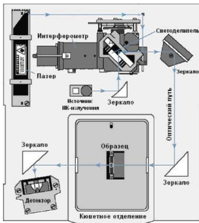
Рисунок 4. – Оптическая схема спектрометра Nicolet 6700
