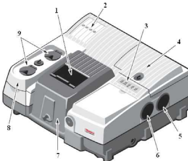
Рисунок 1. – Внешний вид ИК-Фурье спектрометра Nicolet 6700:
