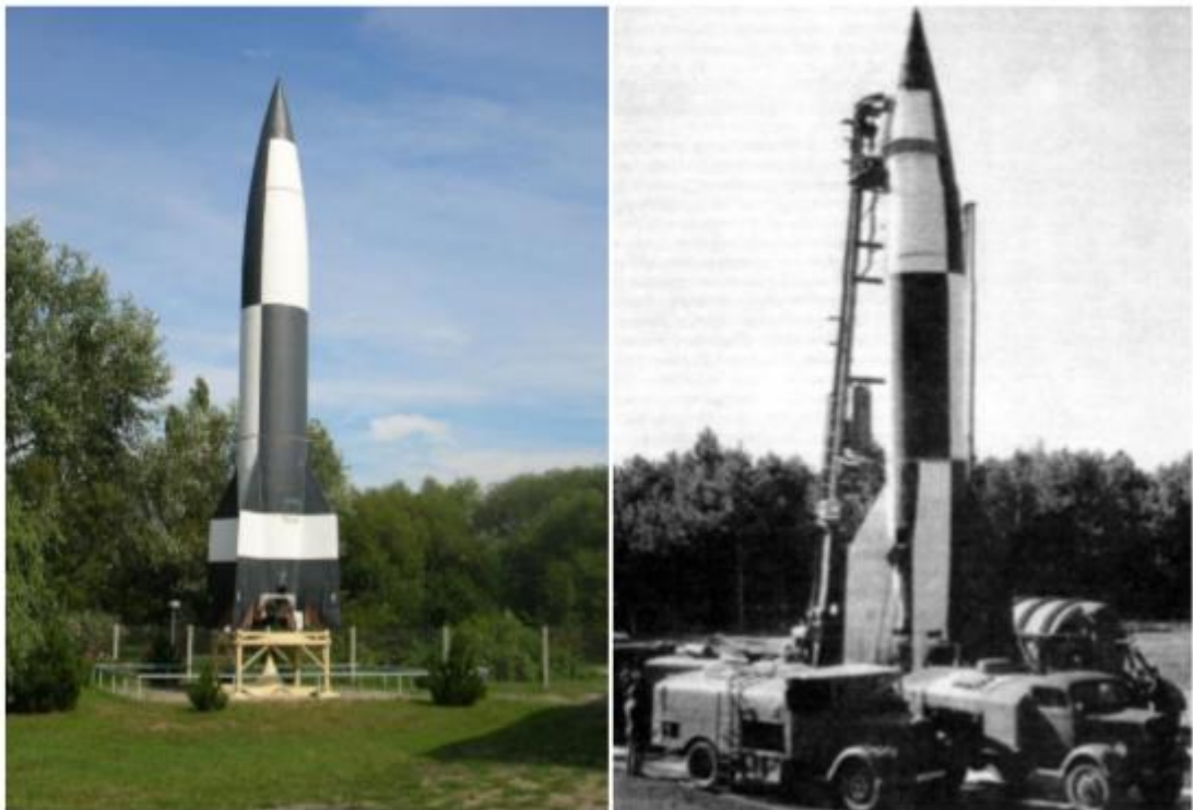
Рисунок 14 - Баллистическая ракета «Фау-2»
