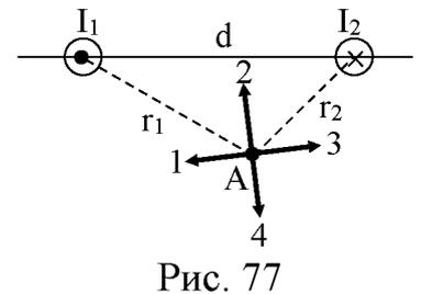
41. На рисунке 78 изображены сечения двух параллельных прямолинейных длинных проводников с противоположно направленными токами, причем  $I_1=2I_2$ . Вектор индукции  $\mathbf{B}$  результирующего магнитного поля в точке А направлен по направлению:
