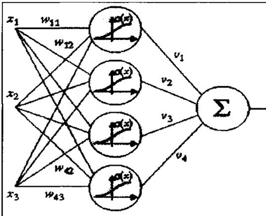
путем объединения выходов нейронов с входами. При этом граф межнейронных соединений может быть ациклическим либо произвольным циклическим. Вид графа служит одним из классификационных признаков типа нейронной сети.
