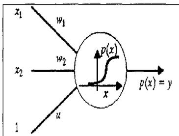
Искусственный нейрон, далее просто нейрон,  $V_j$ ,  $j=\{1,2,\dots,n\}$ , где  $n$ -размерность пространства входных сигналов, задается совокупностью своих входов  $X_{ji}$ ,  $i=\{1,2,\dots,n\}$ , весами входов  $W_{ji}$ , функцией
