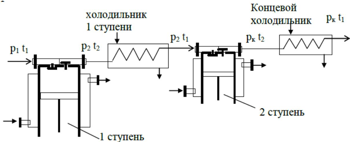
Рис.2. Схема 2-х ступенчатого компрессора
