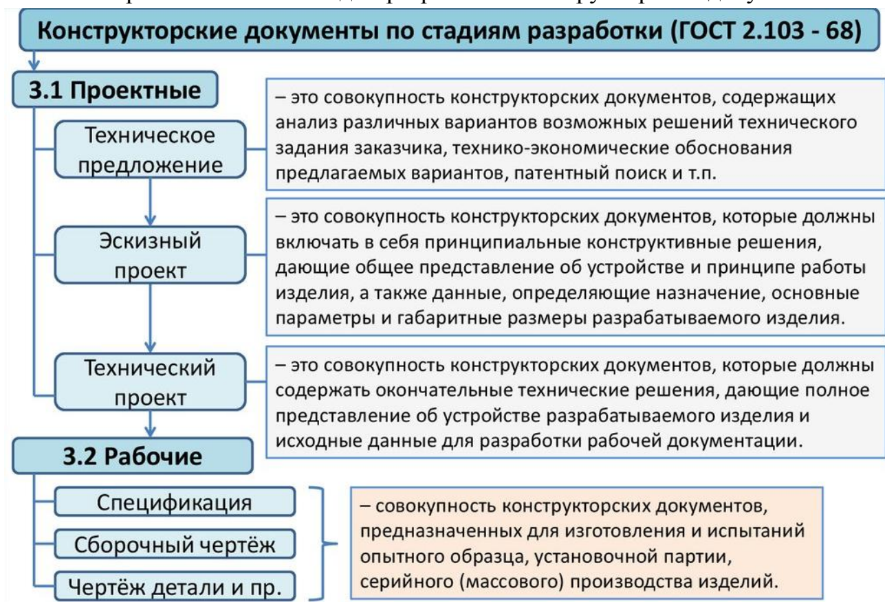
Рис. 2 Стадии разработки конструкторских документов
