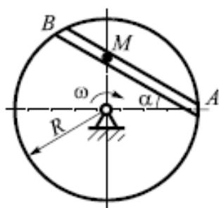
$$\omega = 2t^3 - t^2 \text{ c}^{-1}; V_{\text{отн}} = 30 \sin \frac{\pi t}{6} \frac{\text{см}}{\text{с}}$$
