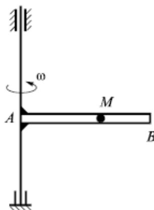
$$\omega = 4\pi t^2 \text{ c}^{-1}; V_{\text{отн}} = 60t^2 + 15 \frac{\text{см}}{\text{с}}$$
