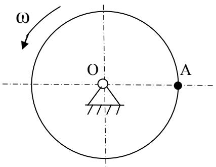
Диск радиусом  $R=1$  (м), вращаясь с постоянным ускорением, за время  $t=\pi/4$  (с) повернулся на угол  $90^0$ , при этом скорость точки  $A$  оказалась равной 4(м/с) (в начальный момент времени диск был неподвижен). Определить угол между скоростью и ускорением точки  $A$  в указанный момент времени, а также угловое ускорение точки.
