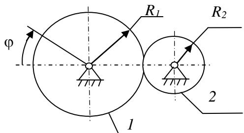
Колесо 1 вращается согласно закону  $\phi_1=20t$  (рад). Определить число оборотов, совершенных колесом 2 за время  $t=3,14$  (с), если радиусы колес  $R_1=0,8$  (м) и  $R_2=0,5$  (м).
