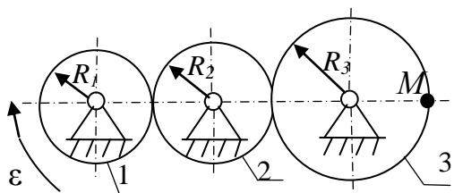
Зубчатое колесо 1 вращается равнопеременно с угловым ускорением  $\varepsilon_1=4$  (рад/с<sup>2</sup>). Определить скорость точки  $M$  в момент времени  $t=2$  (с), если радиусы зубчатых колес  $R_1=0,4$ (м),  $R_3=0,5$  (м). Движение начинается из состояния покоя.
