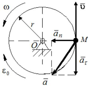
Рис. 2.7 Схема маховика
