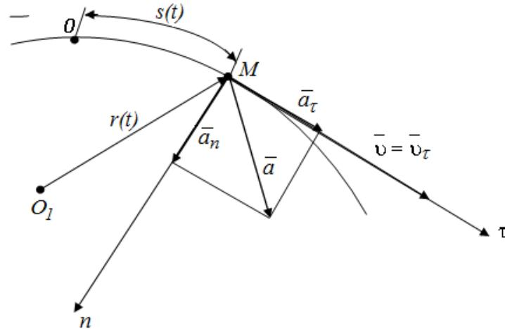
Рис.1.3. Скорость и ускорение точки при естественном способе задания движения точки
