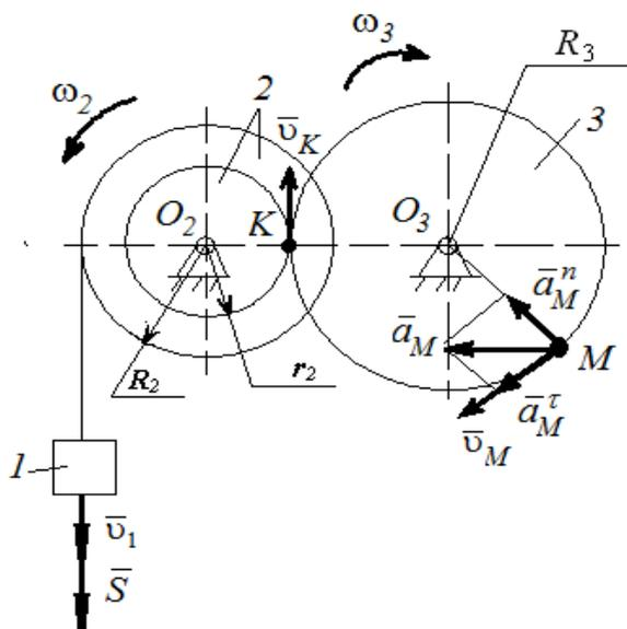
Рис. 2.6. Схема механизма
