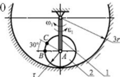
$$\omega_1 = 2 \frac{\text{рад}}{\text{с}}; \quad \varepsilon_1 = 3 \frac{\text{рад}}{\text{с}^2}; \quad r = 15 \text{ см}$$
