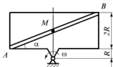
$$\omega = 2\pi t^2 - 4 \text{ c}^{-1}; V_{\text{отн}} = 5t^2 + 7 \frac{\text{см}}{\text{с}}$$
