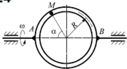
$$\omega = 2t^3 + 3 \text{ c}^{-1}; \quad v_{\text{отн}} = 20t^2 \frac{\text{см}}{\text{с}};$$
