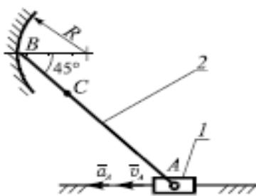
$$v_A = 40 \frac{\text{см}}{\text{с}}; \quad a_A = 25 \frac{\text{см}}{\text{с}^2}; \\ AB = 30 \text{ см}; \quad AC = 20 \text{ см}; \quad R = 10 \text{ см}$$
