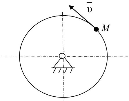
Диск радиусом  $R=0,15$  (м) в момент времени, когда скорость точки  $M$  на его ободе  $v=0,48$  (м/с), начинает вращаться равнозамедленно. До полной остановки диска точка  $M$  прошла путь  $S=0,4$  (м). Определить в указанный момент времени ее ускорение, а также угловую скорость и угловое ускорение диска.
