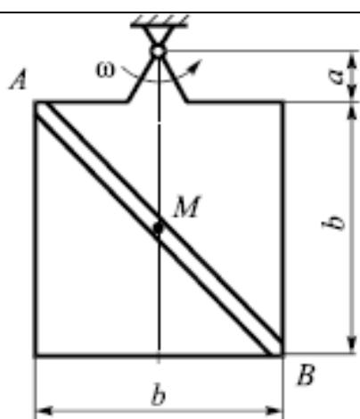
$$\omega = 2t^2 - 3t \text{ c}^{-1}; v_{\text{отн}} = 5 \sin \frac{\pi t}{2} \frac{\text{см}}{\text{с}};$$
