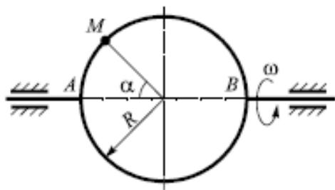
$$\omega = 5t + 3t^2 \text{ c}^{-1}; \quad V_{\text{отн}} = 5\pi t^2 \frac{\text{см}}{\text{с}};$$
