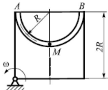
$$\omega = 4t - t^3 \text{ c}^{-1}; \quad v_{\text{отн}} = 25t^2 + 15 \frac{\text{см}}{\text{с}};$$
