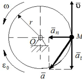
Рис. 2.7 Схема маховика
