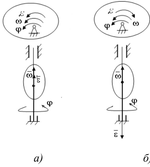
Рис. 2.3. Направление угловой скорости и углового ускорения при вращательном движении твердого тела: *a* – ускоренное движение; *б* – замедленное движение
