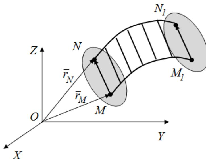
Рис. 2.1. Поступательное движение твердого тела
