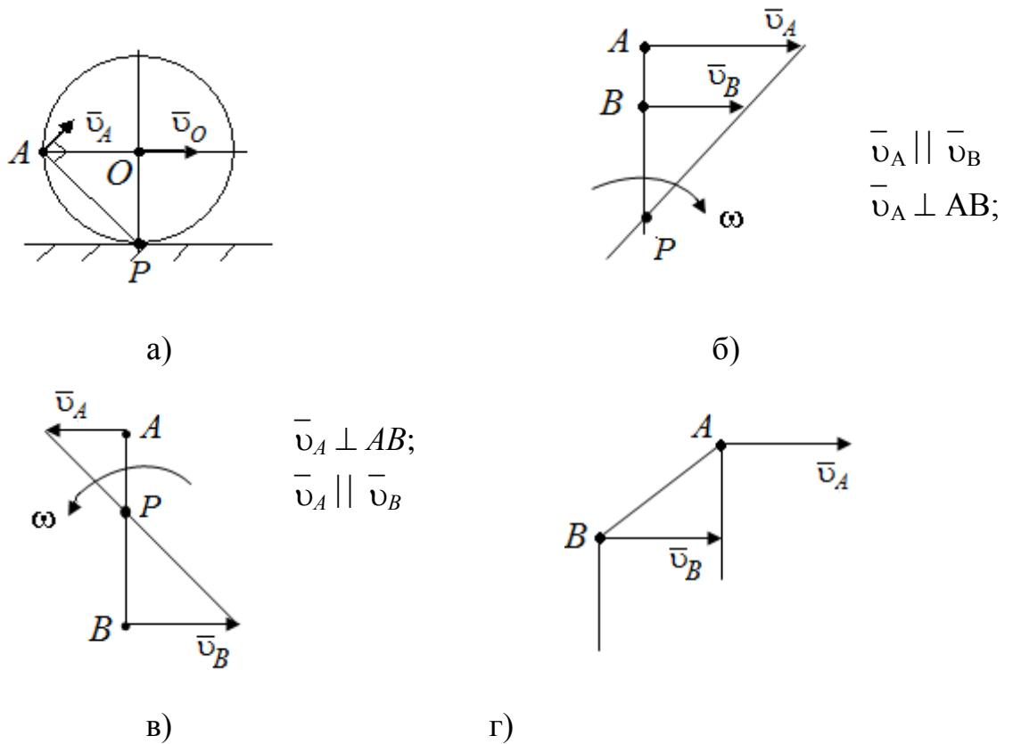
Рис.2.13. Частные случаи нахождения МЦС: а - качение без скольжения; б -  $\bar{v}_A \parallel \bar{v}_B$  и направлены в одну сторону; в -  $\bar{v}_A \parallel \bar{v}_B$  и направлены в противоположные стороны; г -  $\bar{v}_A \parallel \bar{v}_B$ ,  $\bar{v}_A = \bar{v}_B$ , МЦС находится в бесконечности
