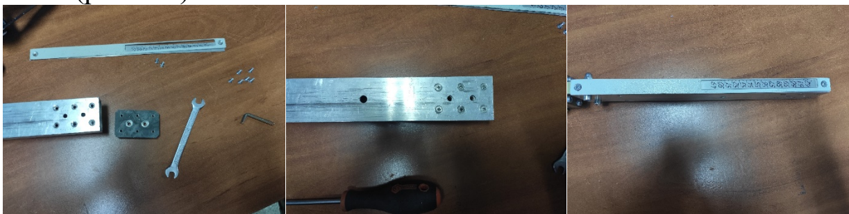
Рисунок 3.9. Присоединение регулировочной пластины и линейки к профилю голени
