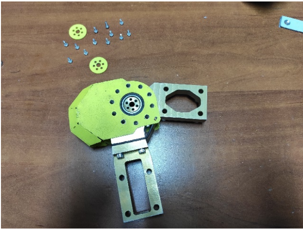
Рисунок 3.5. Место крепления шайб-фланцев и пластиковых накладок
