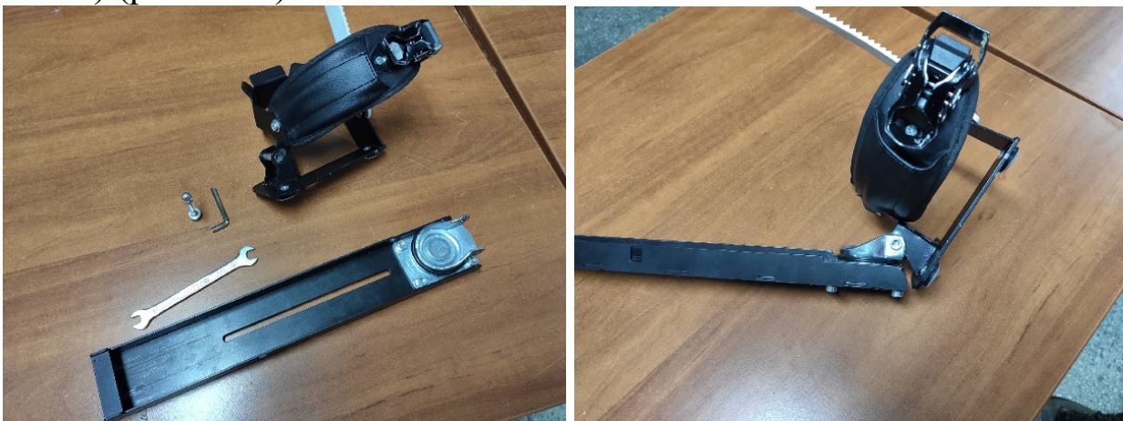
Рисунок 3.11. Соединение стопы и голеностопного шарнира
