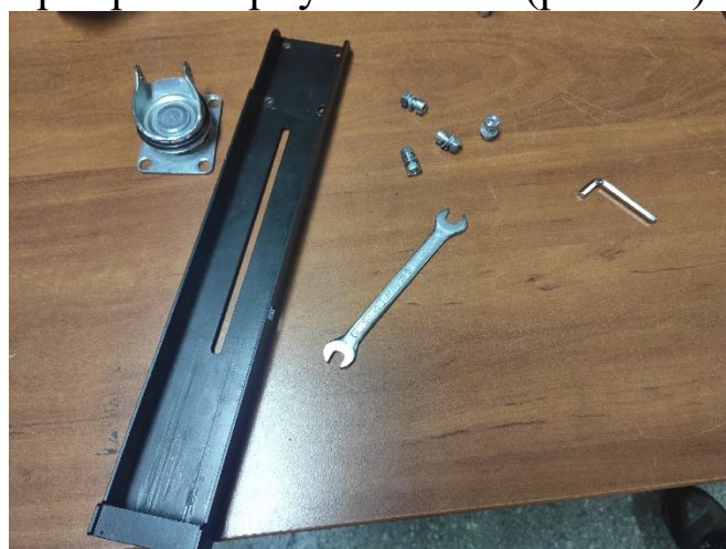
Рисунок 2.4. Шарнир и корпус голени
