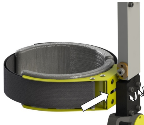
Рисунок 1.11 – Схема регулировки вылета бедренной манжеты
