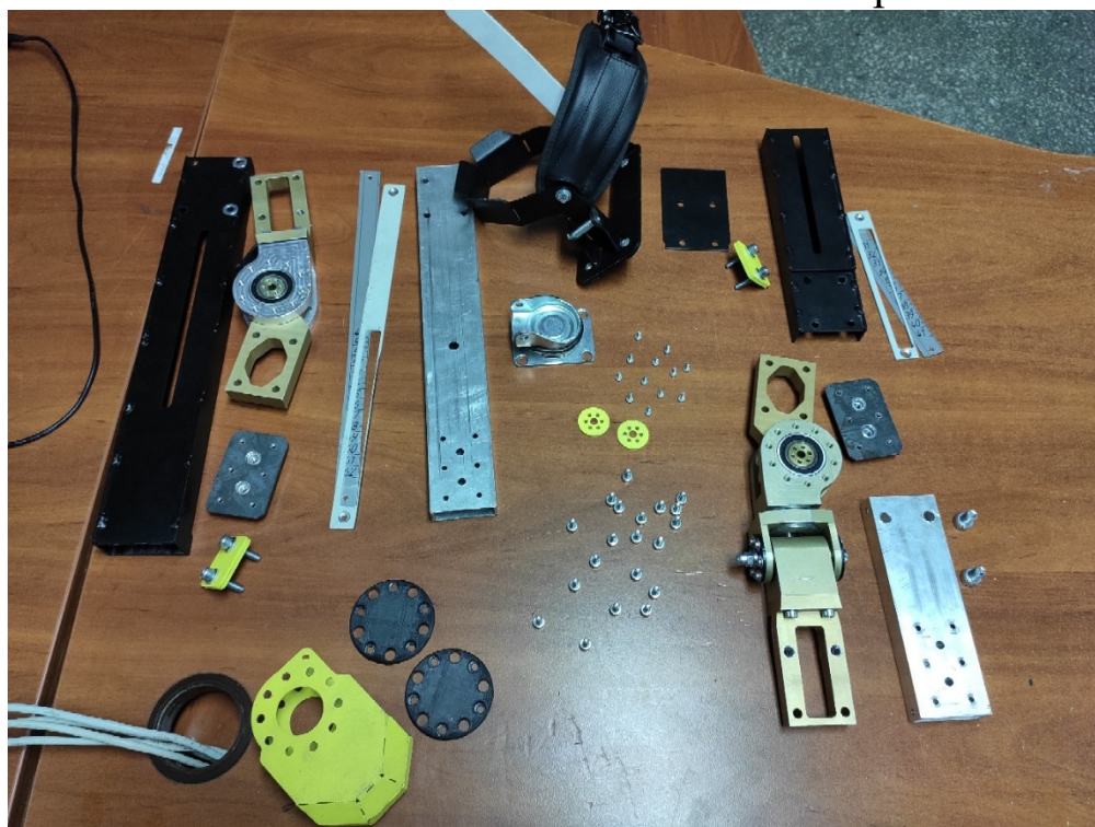
Рисунок 2.14. Разобранная нижняя конечность экзоскелета
