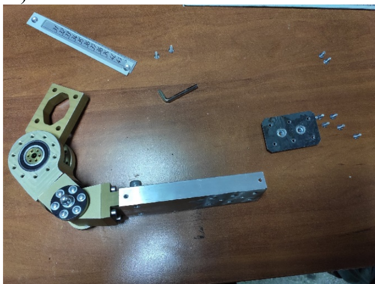
Рисунок 3.2. Место крепления регулировочной пластины и линейки
