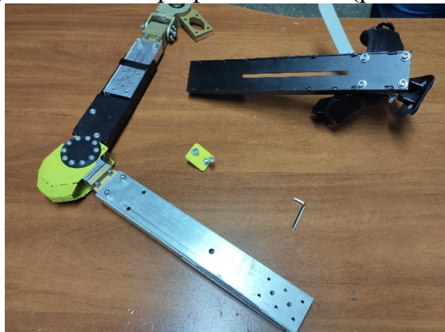
Рисунок 2.2. Рассоединенные регулировочное крепление, корпус голени и профиль голени
