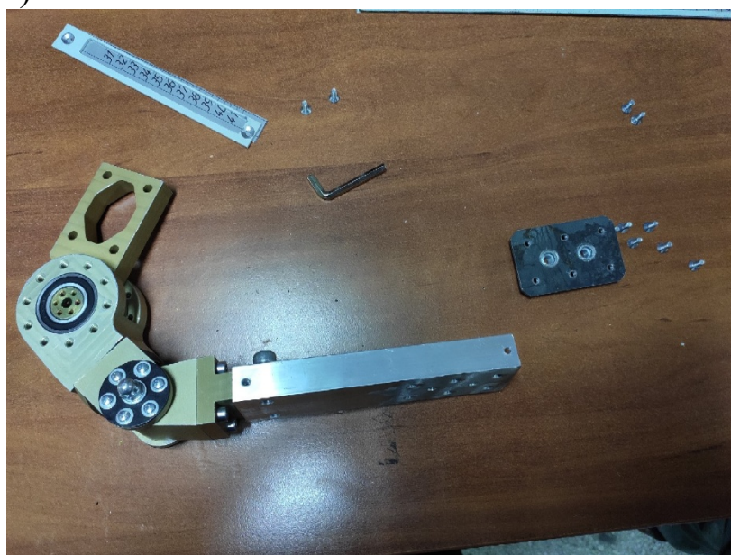
Рисунок 2.12. Отделение линейки и регулировочной пластины от профиля бедра
