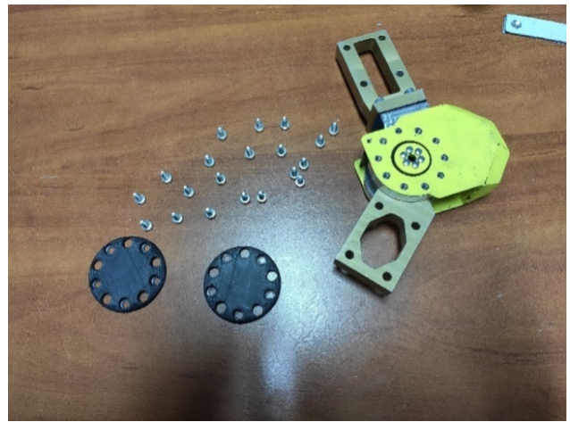
Рисунок 3.5. Место крепления шайб-фланцев и пластиковых накладок
