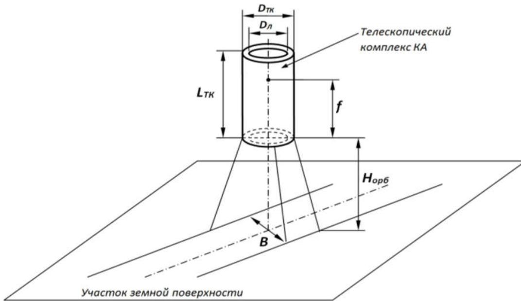
Телескопический комплекс КА:  $L_{TK}$  - длина телескопического комплекса,  $D_{TK}$  - диаметр телескопического комплекса,  $D_{Л}$  - диаметр оптического элемента телескопа (линзы или зеркала),  $f$  - фокусное расстояние оптической системы телескопа,  $H_{орб}$  - высота орбиты КА,  $B$  - ширина полосы обзора.
