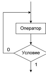
Рис. 2. Граф-схема цикла с постусловием
