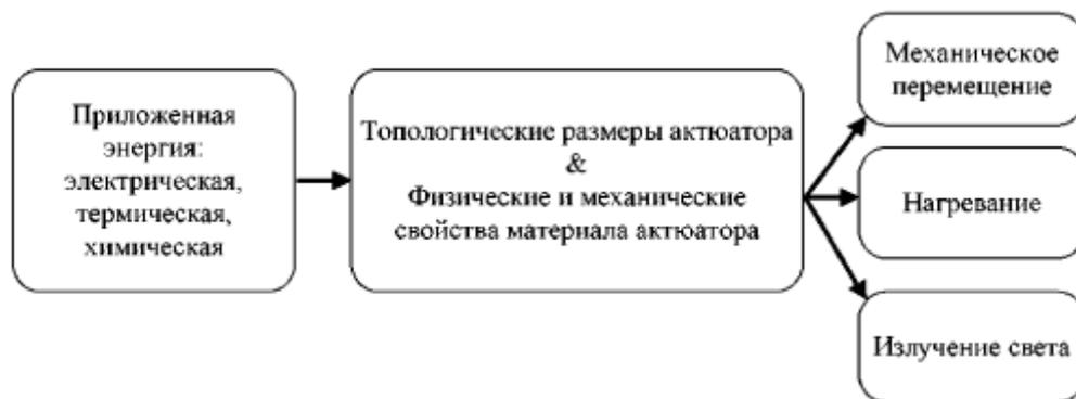
Рисунок 7 - Преобразование входной энергии в работу актюатора
