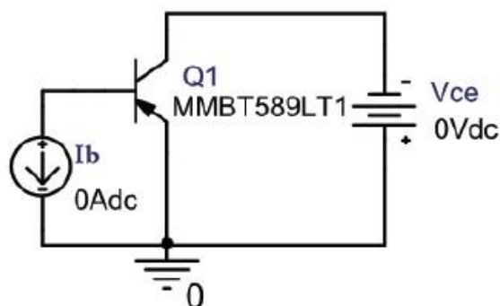
Рисунок 5 - Схема для снятия выходных характеристик БТ с ОЭ в OrCAD
