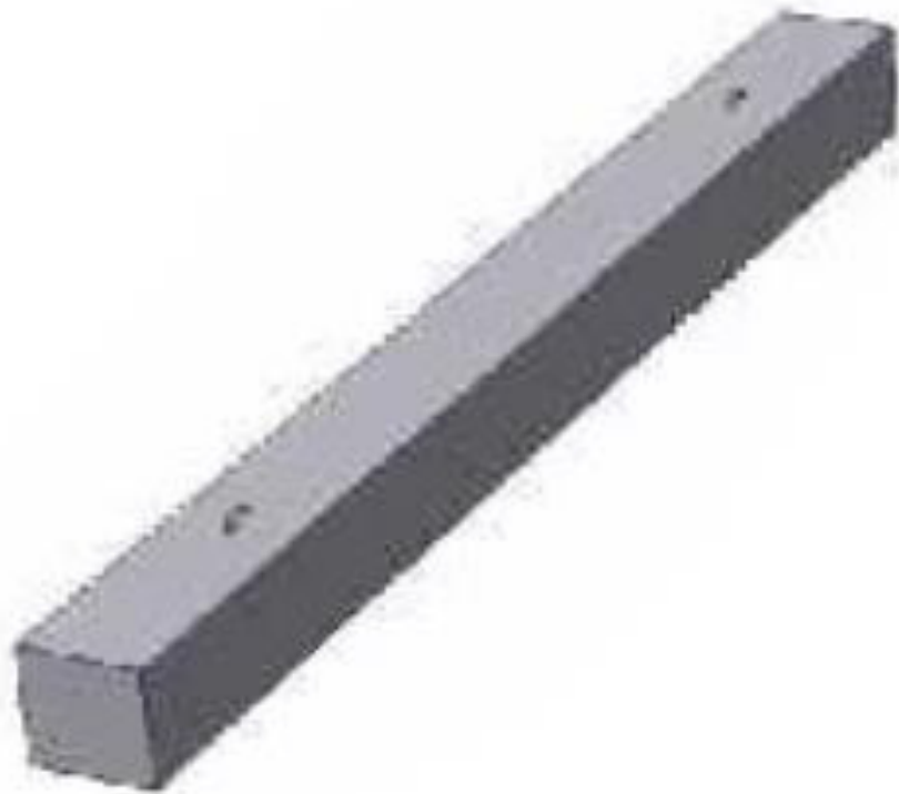
Рисунок 1.15 - Свая с плоским нижним концом
