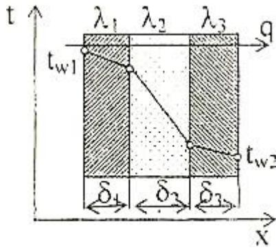
Рис.1. Расчетная схема 3-х слойной плоской стенки
