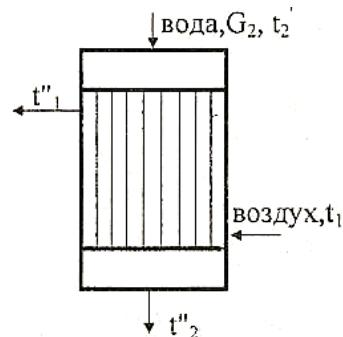
Рис. 4. Расчетная схема теплообменного аппарата
