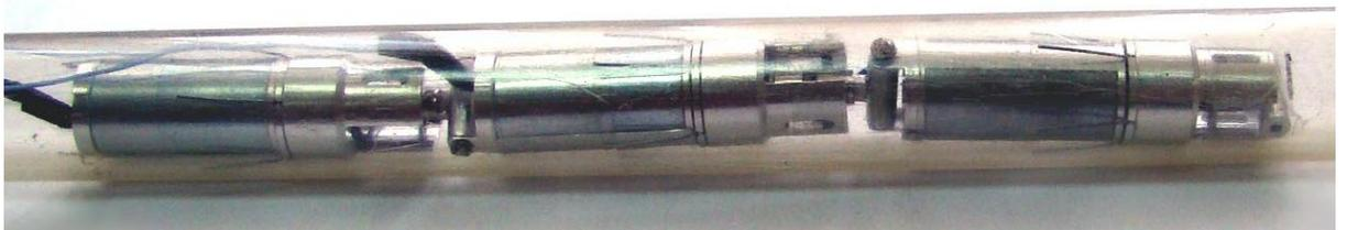
Рис. 4.1 Трехмодульный робот для перемещения внутри трубопроводов
