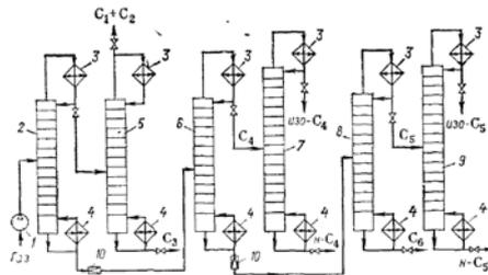
5. На технологической схеме разделения углеводородов  $C_1-C_5$  укажите кипятыльник:
