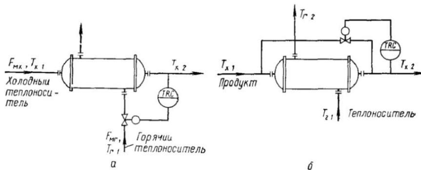
2. На приведенной схеме регулирования работы теплообменников укажите схему, использующую конденсат и воздействия на расход греющего пара. Какая из приведенных схем эффективнее? Поясните ответ.
