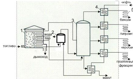
8. На приведенной схеме начальной стадии переработки нефти укажите испарительную колонну
