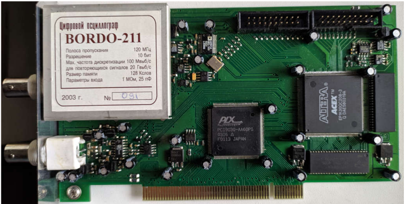
Рисунок 4.1 – Плата цифрового осциллографа с частотой дискретизации 100 МГц в режиме реального времени и 20 ГГц в стробоскопическом режиме, устанавливаемая в разъем PCI персонального компьютера
