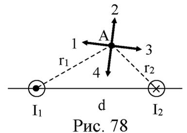
42. На рисунке 79 изображены сечения двух параллельных прямолинейных длинных проводников с противоположно направленными токами, причем  $I_1=2I_2$ . Вектор индукции  $\mathbf{B}$  результирующего магнитного поля в точке А направлен по направлению:
