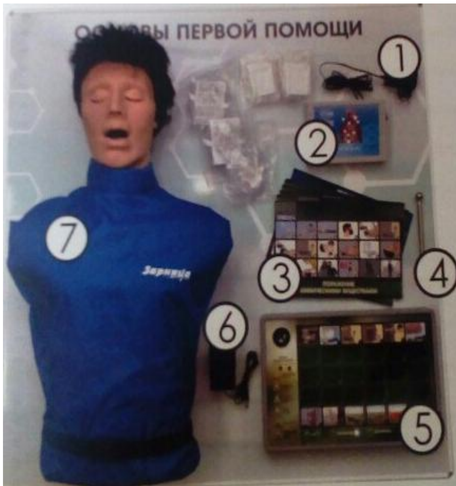
Рисунок 2 - Многофункциональный интерактивный учебно-тренажерный комплекс: 1 – адаптер питания модуля тестирования и контроллера; 2 – контроллер; 3 – комплект фольг; 4 – элемент управления по обучению; 5 – модуль тестирования; 6 – адаптер питания робота-тренажера; 7 – робот-тренажер
