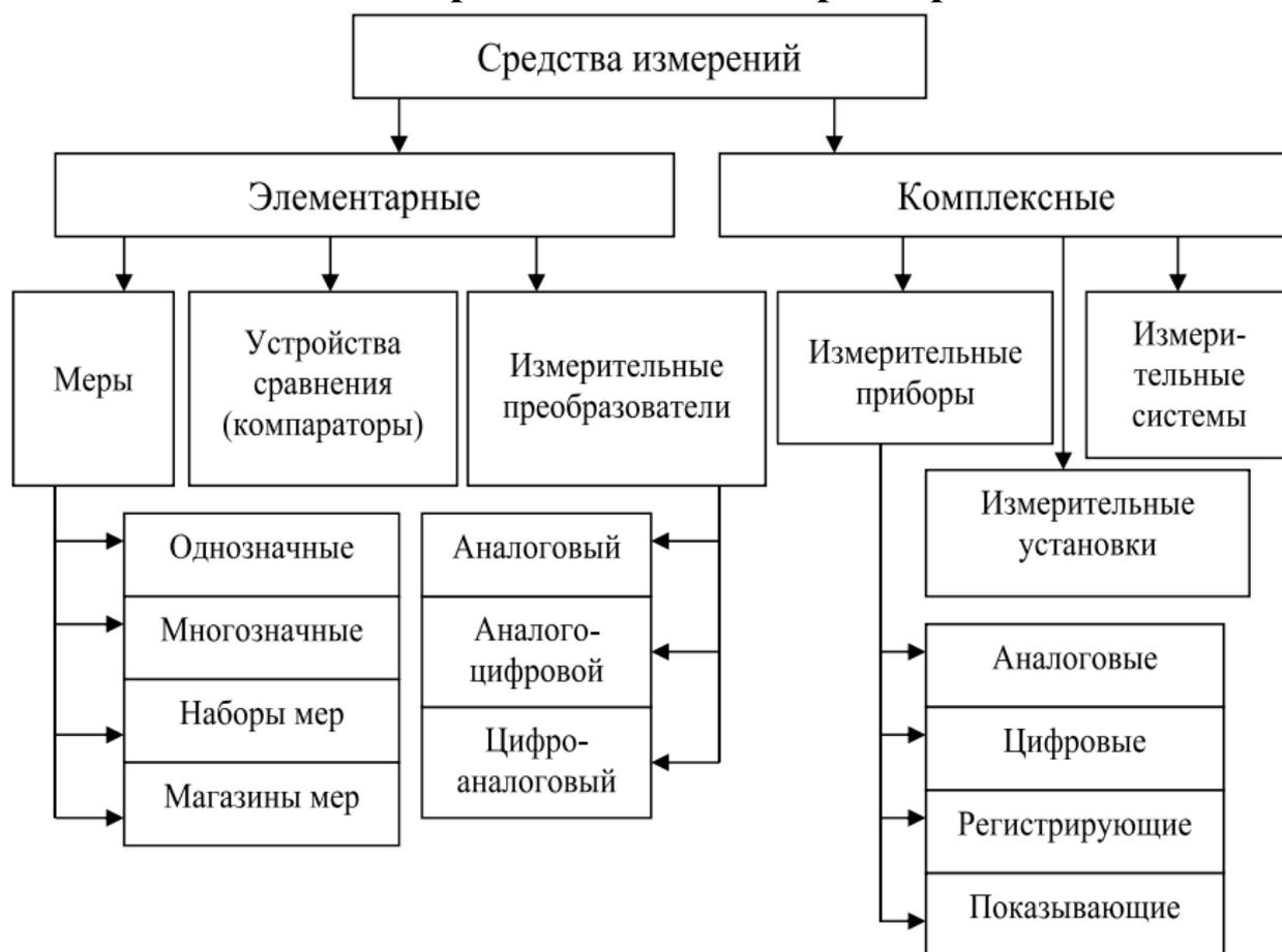
Рисунок 1 – Классификация средств измерения по техническому назначению
