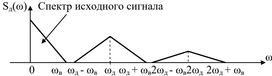
Рисунок 4 – Типовой спектр АИМ сигнала
