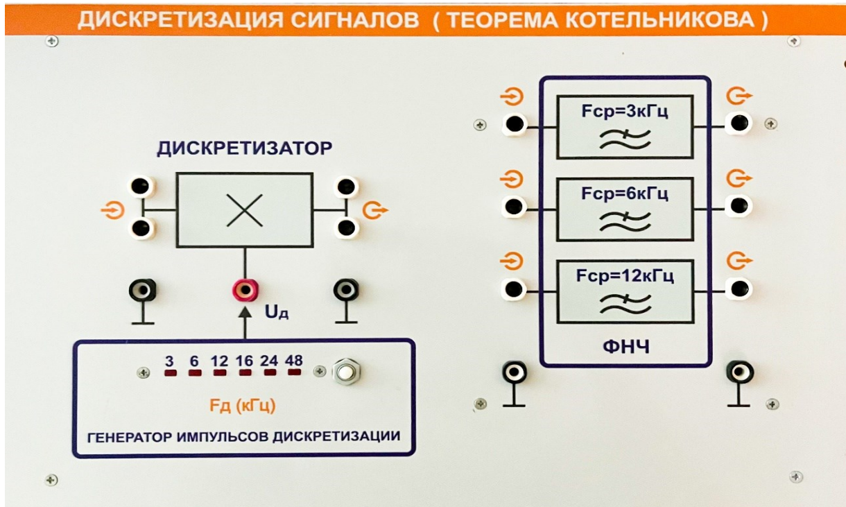
Рисунок 1 – Передняя панель сменного блока «ТЕОРЕМА КОТЕЛЬНИКОВА»
