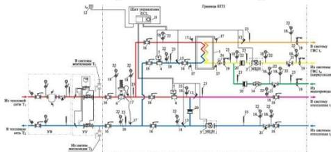
А) зависимое присоединение системы отопления и системы ГВС с одноступенчатымводоподогревателем
