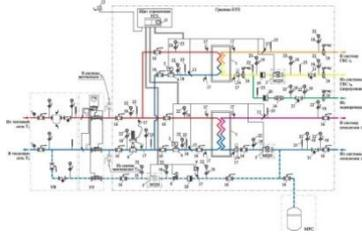
А) независимое присоединение 2-х систем отопления и системы ГВС с одноступенчатымводоподогревателем
