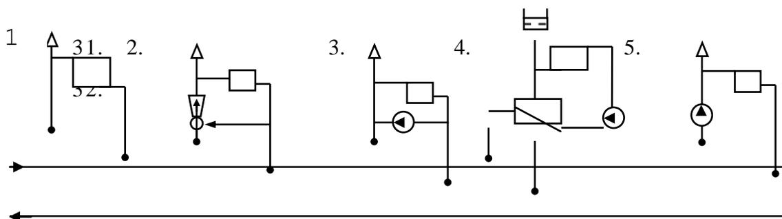
11. Можно ли использовать в качестве циркуляционного насоса, развивающий напор 3 м.вод.ст, если перепад давлений в тепловой сети - 20 кПа, а гидравлические потери в системе отопления - 60 кПа?
