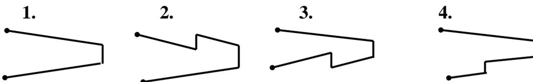
3. Укажите график температуры сетевой воды в обратном теплопроводе  $\tau_{20}(t)$  (в диапазоне наружных температур  $t_{ex} \leq t \leq 8^\circ\text{C}$ ) при сочетании центрального качественного и местного количественного регулирования отпуска теплоты:
