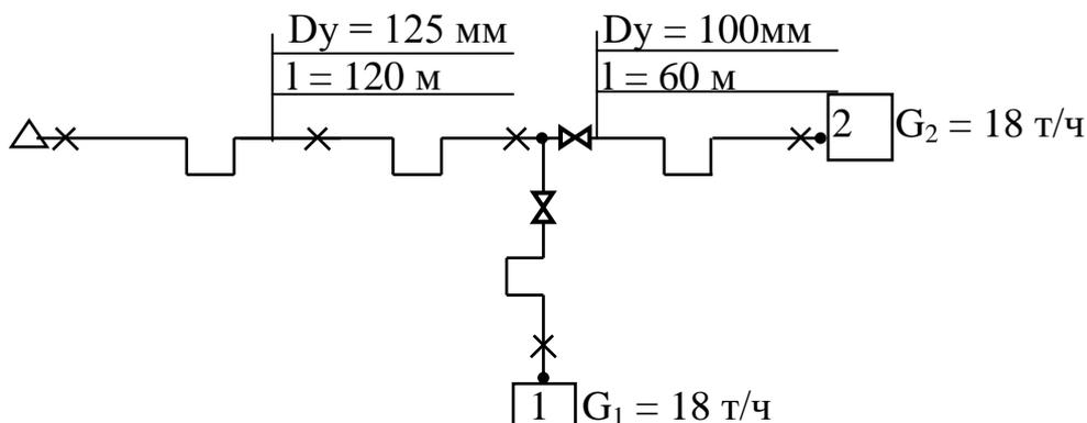
Определите располагаемый напор на вводе потребителя № 2, если в начальной точке  $H_r = 20$  м в.ст.. Отводы – крутоизогнутые; плотность воды – 958,4 кг/м<sup>3</sup>; эквивалентная шероховатость стенок труб – 0,0005 м. Расчет выполнить по формулам.
