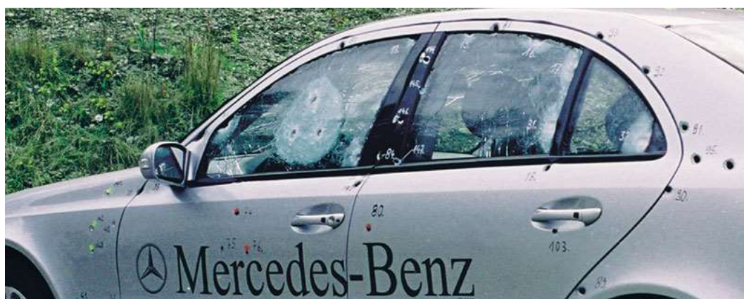
Рис. 14 Пример баллистических испытаний
