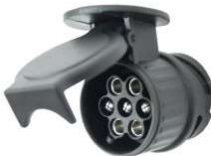
Рис. 9 Розетка для подключения приборов прицепа
