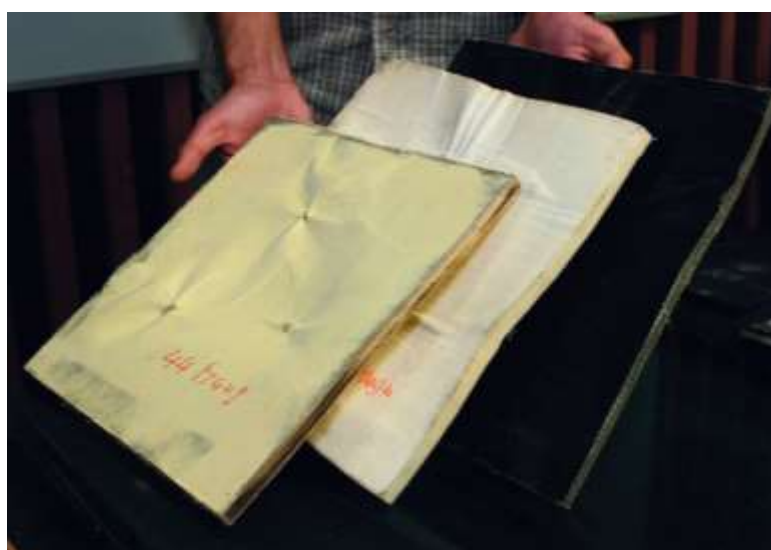
Рис. 17 Многослойные композитные пластины
